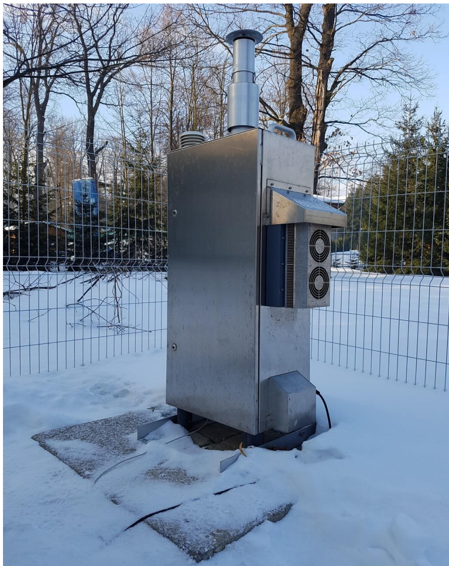
Fot.1. Pobornik pyłowy zainstalowany w punkcie pomiarowym
